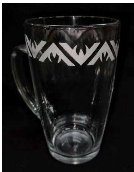
Рисунок 3. Образец из силикатного стекла с нанесенным покрытием
